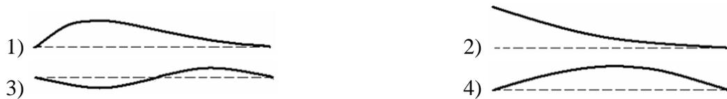
48. Вывод формулы Эйлера для критической силы сжатого стержня основан на предположении, что под действием сжимающей силы, равной критической силе, стержень изогнется, при этом...
